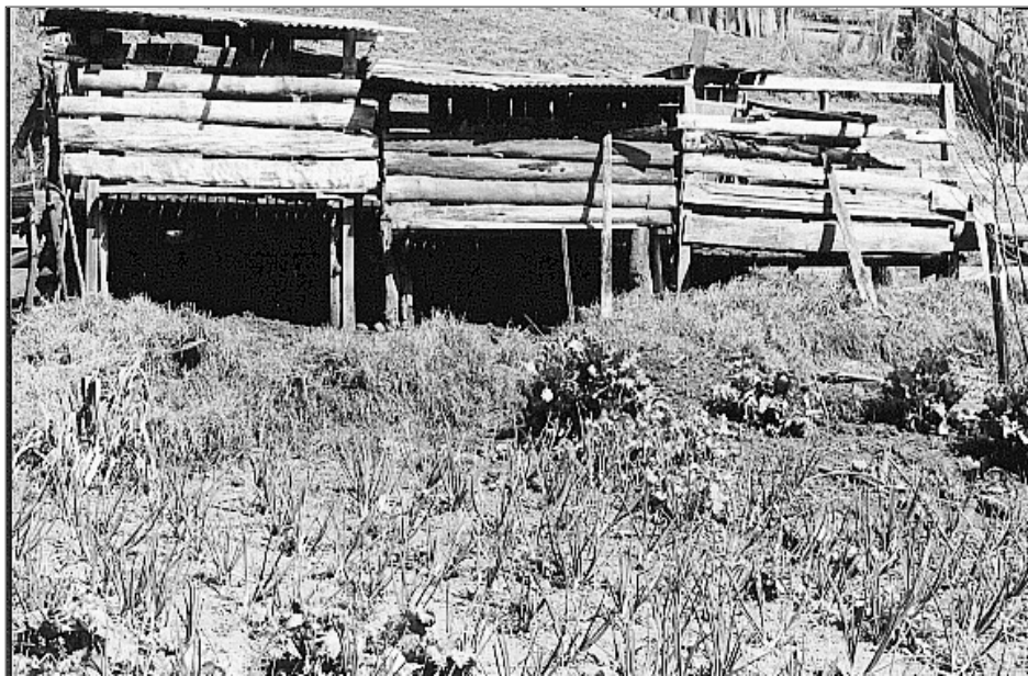
Vista de un corral alternativo elaborado con materiales locales, incluye divisiones para sementales y crías, techo de lámina, piso de madera y enrejado. (Foto: Trinidad Alemán)
